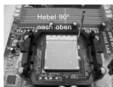
SCHRITT 1: Ziehen Sie den Sockelhebel hoch
